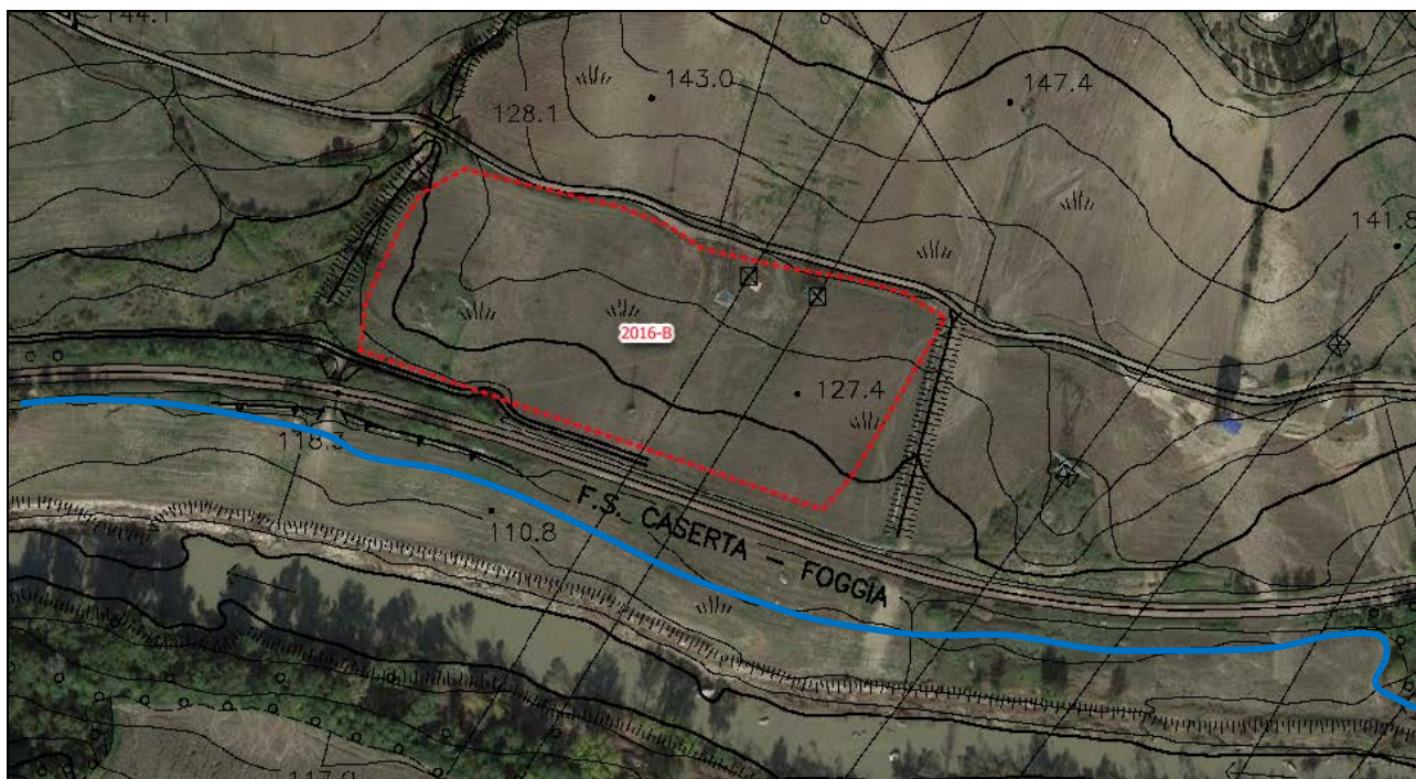
Figura 26: Ripresa zenitale del possibile sito di realizzazione del depuratore. In blu la linea di massimo alluvionamento a seguito dell'evento del 15 e 19 ottobre 2015. Comune di Benevento – loc. Masseria Sciabbacca.
